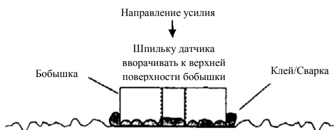
Рисунок 4 - Установка датчика бобышкой
